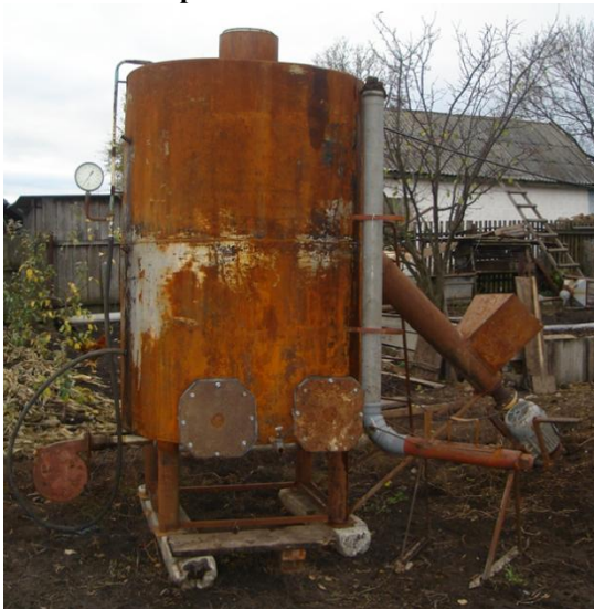
Рисунок 3 - Ферментер та установка для подачі органічної маси
