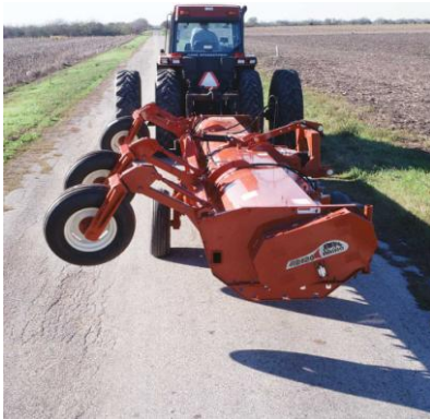
Рисунок 3 - Подрібнювач-розподільувач рослин і поживних залишків RC120 фірми „Rhino” (США): а – під час транспортування; б – в роботі
