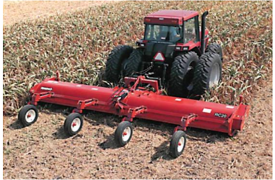
Рисунок 3 - Подрібнювач-розподільувач рослин і поживних залишків RC120 фірми „Rhino” (США): а – під час транспортування; б – в роботі
