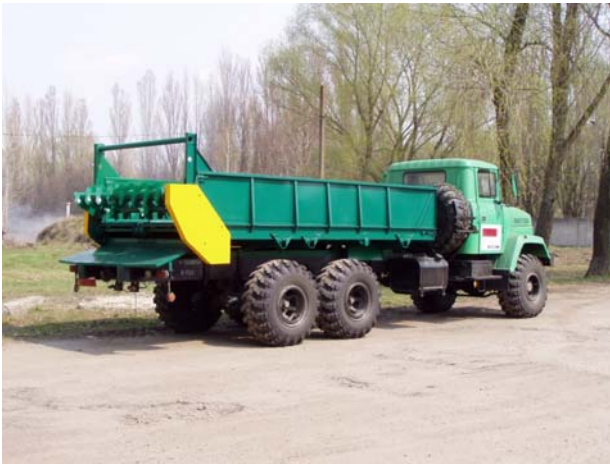
Рисунок 5 – Агрегат для внесення твердих органічних добрив АРОД-11 на базі автомобільного шасі КрАЗ-6322
