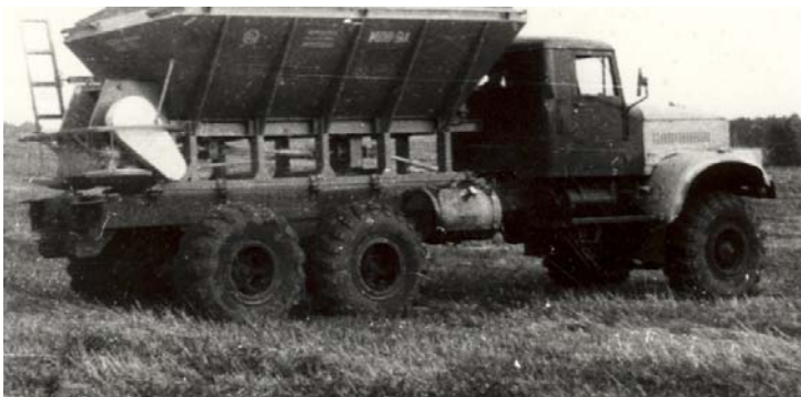
Рисунок 1 – Автомобіль КрАЗ-255Б1, обладнаний машиною для внесення мінеральних добрив і хімічних меліорантів МРД-9А
