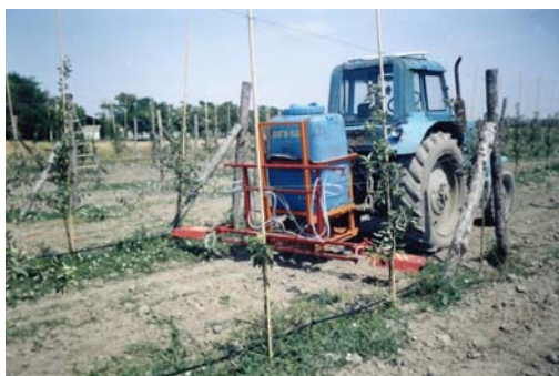
Рисунок 4 – Обприскувач для внесення гербіцидів ОНГВ-500 в роботі (НВП «Наука», м. Сімферополь»)
