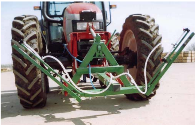
Рисунок 9 – Переднє навісне обладнання зі штангами обприскувача для внесення гербіцидів «Eurolux 800 TM» («Lemken», Німеччина)
