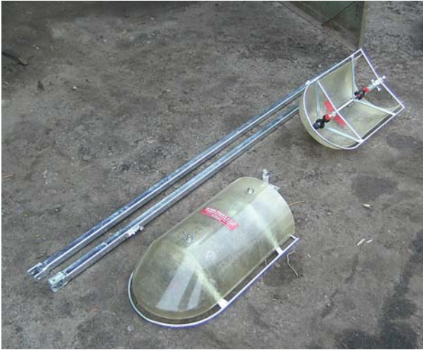
Рисунок 8 – Змінні робочі органи обприскувача для внесення гербіцидів GDE 400
