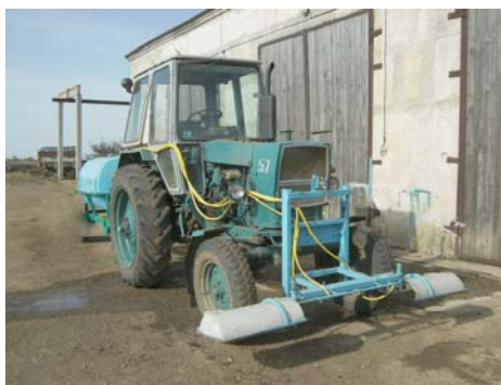
Рисунок 3 – Обприскувач для внесення гербіцидів МВГ-300/500 (НВП «Наука», м. Сімферополь»)
