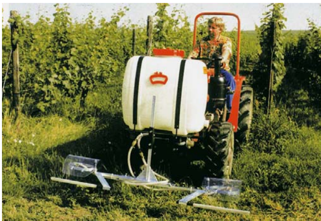
Рисунок 6 – Обприскувач для внесення гербіцидів «Herbika 150» («Müller & Sohn Spezialmaschinen GmbH», Німеччина)
