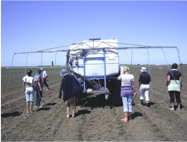
Рисунок 10 – Комплектація обприскувача для внесення гербіцидів «Eurolux 800 TM» ручними виносними штангами (на задній навісці трактора)
