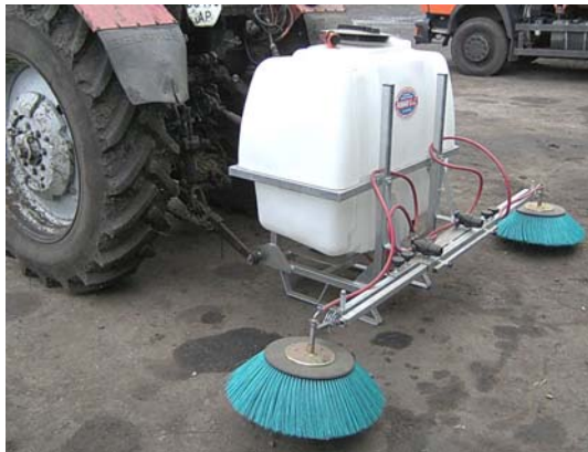
Рисунок 7 – Обприскувач для внесення гербіцидів GDE 400 із захисними щітковими барабанами («Off. Mess. Panari Giancarlo & C. s.n.c.»), Італія)
