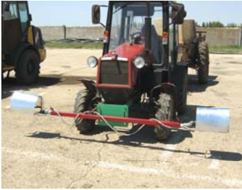
Рисунок 11 – Гербіцидна штанга, виготовлена в умовах господарства
