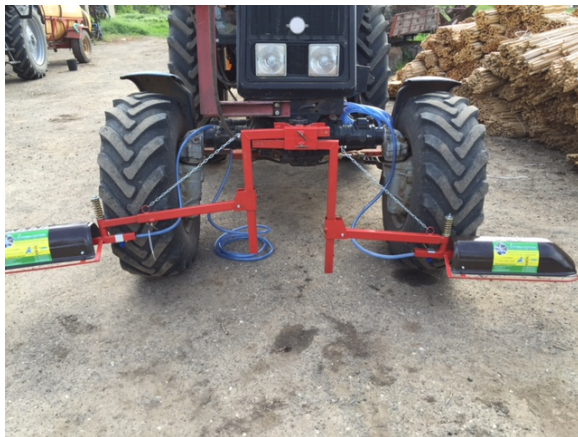
Рисунок 5 – Пристосування для внесення гербіцидів «Maximarin» (ПП «Агрореммаш-Спецтехніка», м. Кіровоград)
