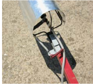
Рисунок 11 – Гербіцидна штанга, виготовлена в умовах господарства
