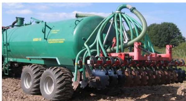
*б) машина с адаптером дисковым для внутривпочвенного внесения жидкого навоза*
