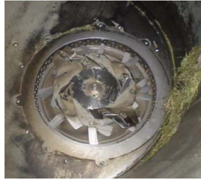
Рисунок 5 – а) Загальний вигляд подрібнювача сировини ГТІС-1; б) Загальний вигляд фрези-ротора подрібнювача
