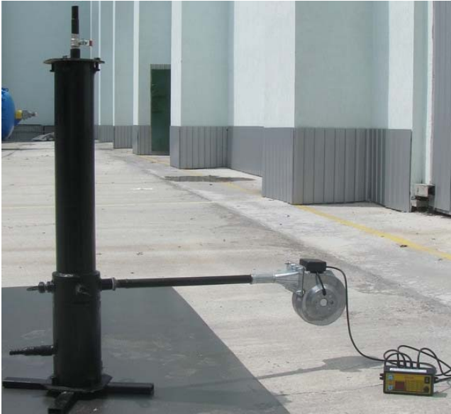
Рисунок 2 – Дослідна установка у складі генератора горючого газу, вентилятора, системи керування
