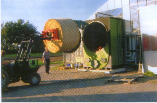
Рисунок 13 – Газогенераторний котел фірми HERLT для великих тюків та деревини
