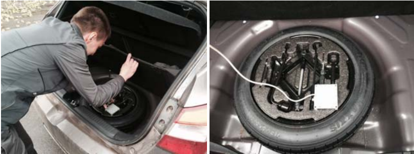
а – встановлення акселерометра; б – закріплений акселерометр Рисунок 2 – Установка і закріплення акселерометра
