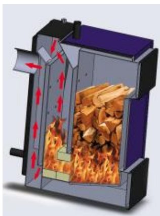
Рисунок 3 – Процес горіння в котлі СДК-15
