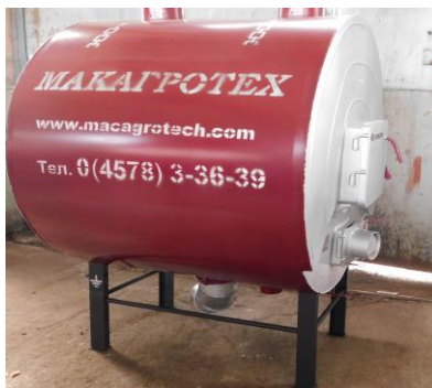
Рисунок 1 – Загальний вигляд теплогенератора ТГУ-1200
