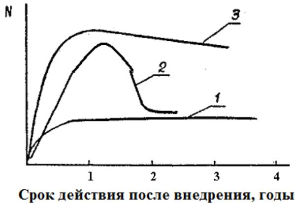
*N – число отказов за год; 1- кривая отказов в условиях управления качеством; 2- кривая отказов в условиях системы контроля качества; 3- кривая отказов в условиях отсутствия системы управления качеством*
