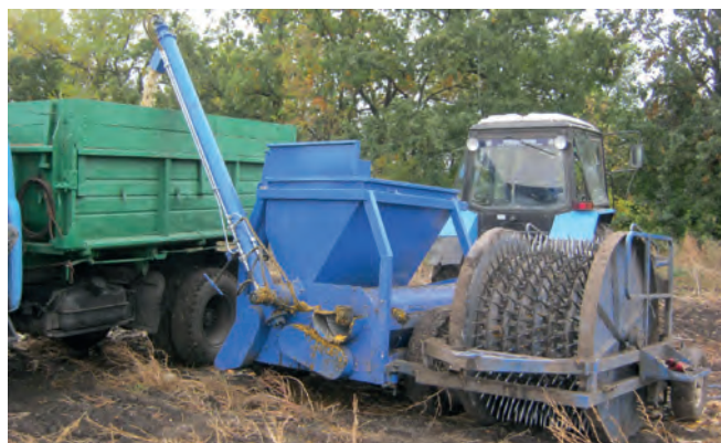
Рисунок 5 - Вивантаження насіння комбайном V-VD.04
