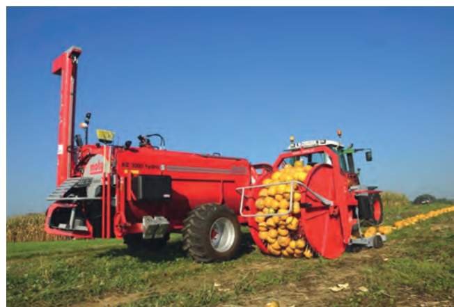
Рисунок 7 – Комбайн для збирання плодів гарбуза та виділення насіння марки «MOTU» («Kröpfel Landmaschinen GmbH», Австрія)
