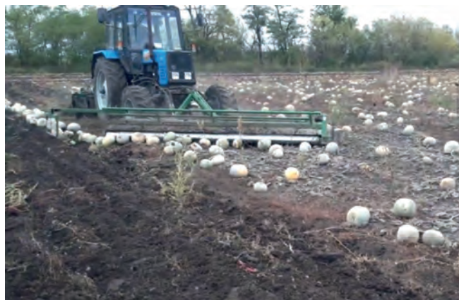
Рисунок 1 – Валкоутворювач плодів гарбуза V-VZ.001 (ПрАТ «Каховський експериментальний машинобудівний завод», Україна)
