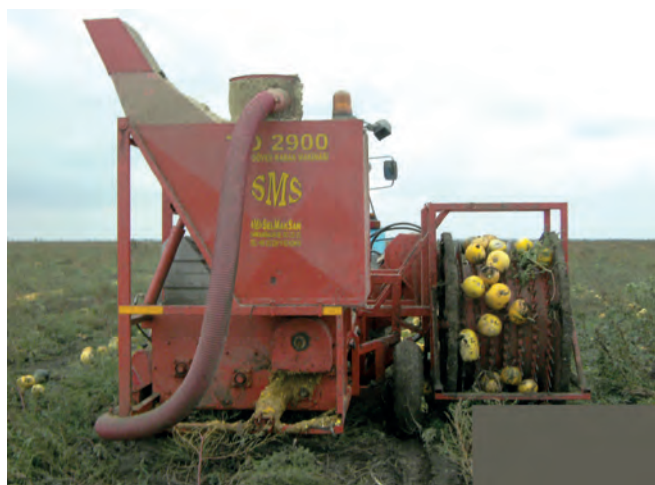
Рисунок 6 – Комбайн для збирання плодів гарбуза та виділення насіння TD-2900 (компанія «SMS», Туреччина)
