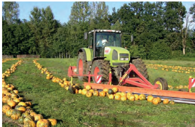
Рисунок 2 – Валкоутворювач плодів гарбуза марки «MOTY» («Kröpfel Landmaschinen GmbH», Австрія)
