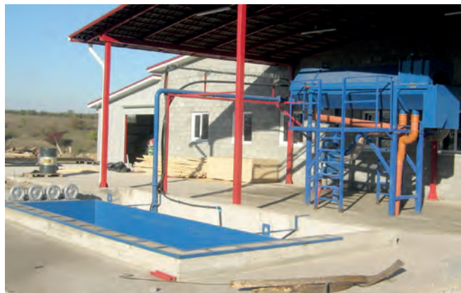
Рисунок 11 – Загальний вигляд мийної машини V-BD440 та бункера V-AB663 (ПрАТ “Каховський експериментальний машинобудівний завод”, Україна)
