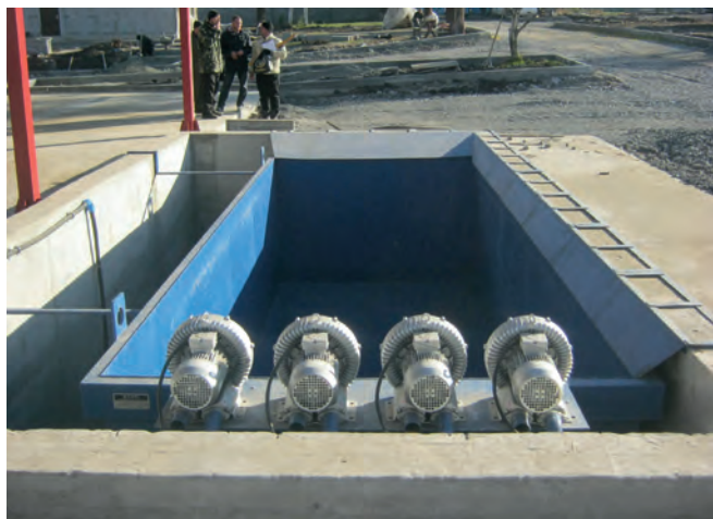
Рисунок 9 – Загальний вигляд бункера V-AB663 з компресорами нагнітання повітря (ПрАТ “Каховський експериментальний машинобудівний завод”, Україна)
