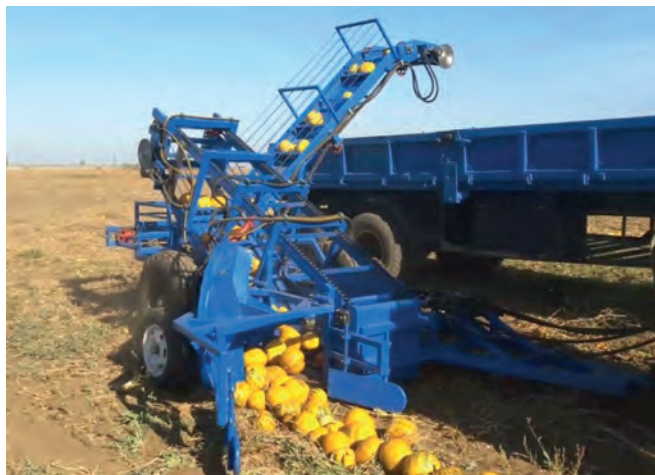
Рисунок 8 – Дисковий підбирач плодів гарбуза з валків V-VB.002 (ПрАТ “Каховський експериментальний машинобудівний завод”, Україна)
