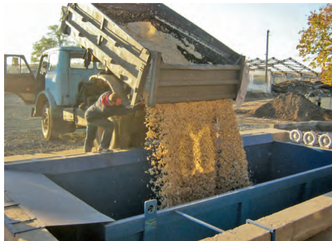
Рисунок 10 – Завантаження приймального резервуара бункера
