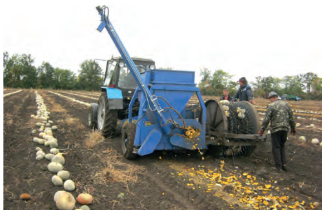
Рисунок 3 - Комбайн для збирання плодів гарбуза та виділення насіння V-VD.04 (ПрАТ "Каховський експериментальний машинобудівний завод", Україна)
