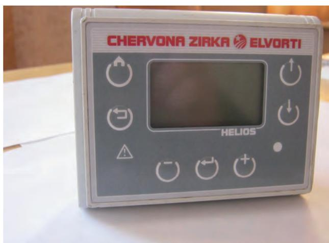
**Рисунок 5** – Пульти системи керування і контролю висіву
