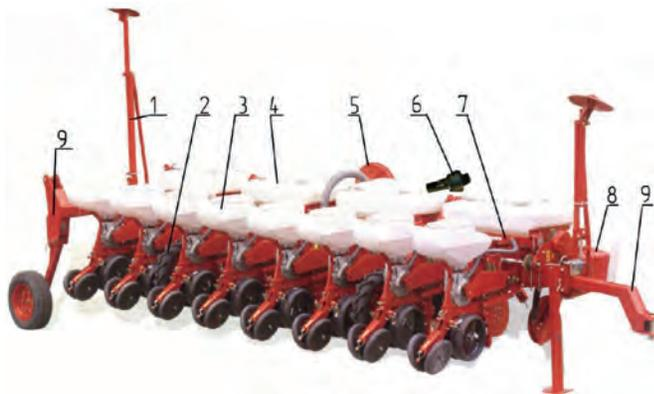
1 – маркер; 2 – опорно-приводне колесо; 3 – посівна секція; 4 – туковисівна система; 5 – вентилятор;
