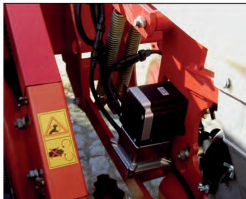
**Рисунок 2** – Електродвигун привода висівних апаратів
