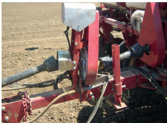
**Рисунок 3** – Привод генератора сівалки пасовою передачею від проміжної опори карданного вала
