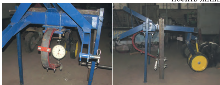
Рисунок 3 – Вигляд стенда з динамометром та гвинтами для забезпечення зусиль переміщень у вертикальній (а) та горизонтальній (б) площинах
