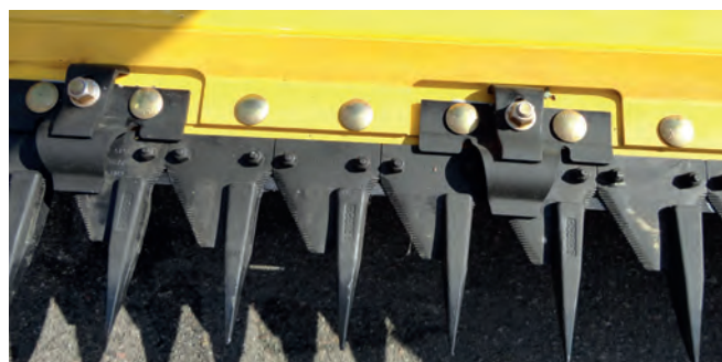
Рисунок 5 – Класичний сегментно-пальцевий різальний апарат
