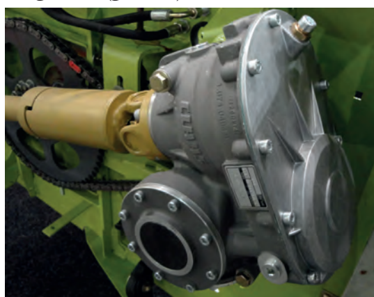
Рисунок 6 – Редуктор для приводу ножа широкозахватної жатки
