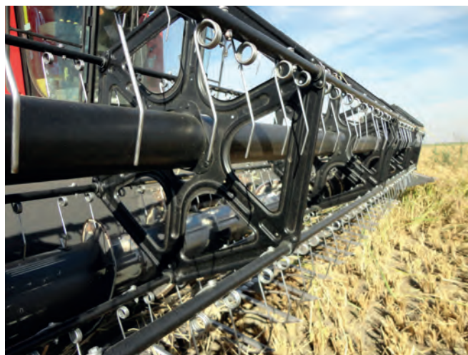
Рисунок 4 – Мотовило з центральною трубою, жорсткими дисками та металевими фігурними пальцями
