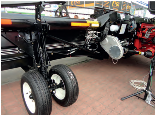
Рисунок 2 – Ходова система зернової жатки (компанія «Мак – Дон»)
