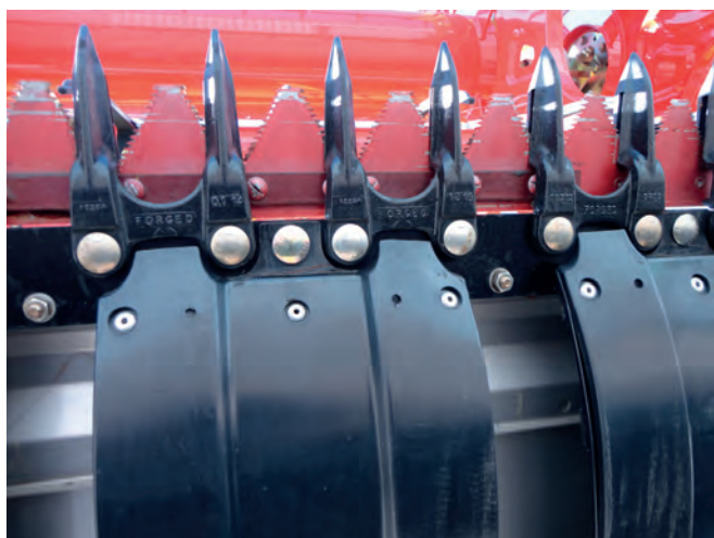
Рисунок 7 – Гнучкі копіювальні щитки днища жатки Flex
