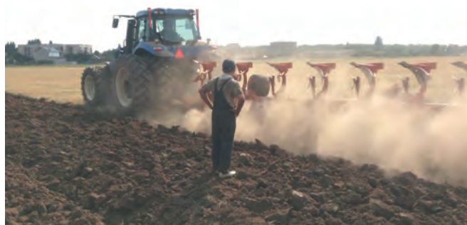
Рисунок 6 – Закладання ділянки під оранку трактором New Holland та 8-корпусним плугом оборотним (DRAGON) 30-32 см
