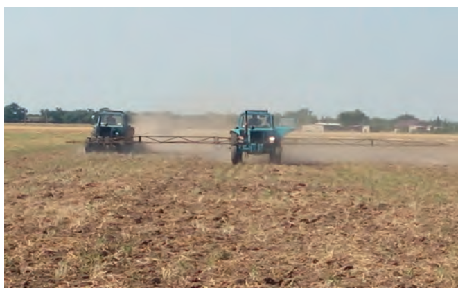
Рисунок 2 – Внесення деструкторів з одночасним загортанням у ґрунт
