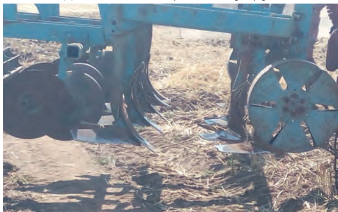
Рисунок 3 – Вигляд робочих органів КЛД -4 перед обробитком ґрунту на глибину 12-14 см
