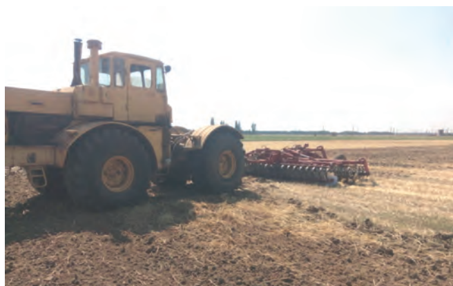
Рисунок 4 – Поверхневий обробіток дисковою бороною Паллада – 6000 на глибину 6-8 см
