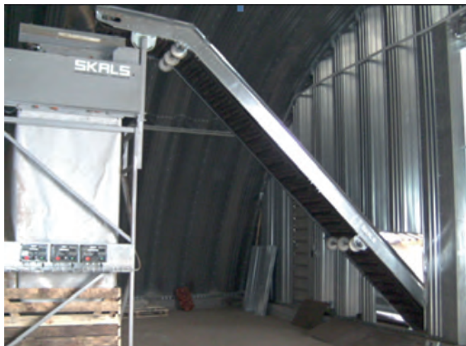
Рисунок 2 – Машина для видалення ґрунту R-908
