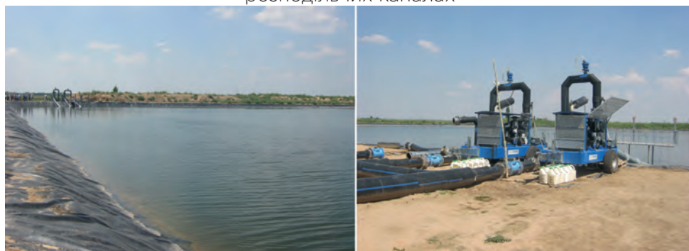
Рисунок 3 – Робота групи дизельних насосних станцій на басейні-накопичувачі
