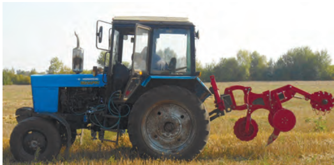
Рисунок 2 – Експериментальна секція агрегата для смугового обробітку ґрунту
