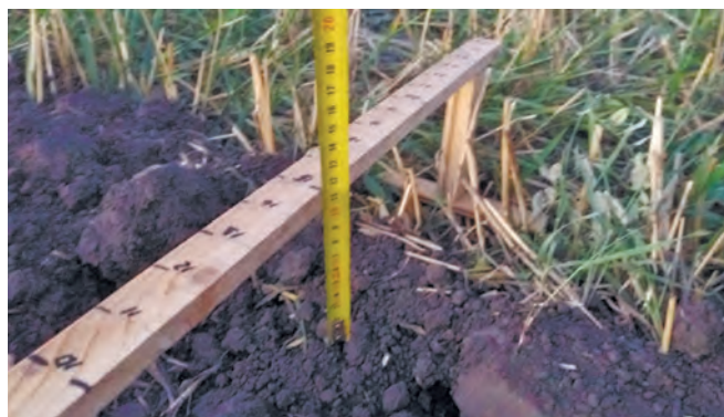
Рисунок 3 – Вимірювання поперечної нерівності
