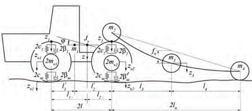
**Рисунок 1** – Розрахункова схема вертикальних коливань трелювального колісного трактора з пакетом хлистів
