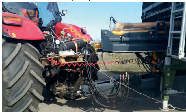
Рисунок 4 – Імітатор гальмування, встановлений на тракторі
