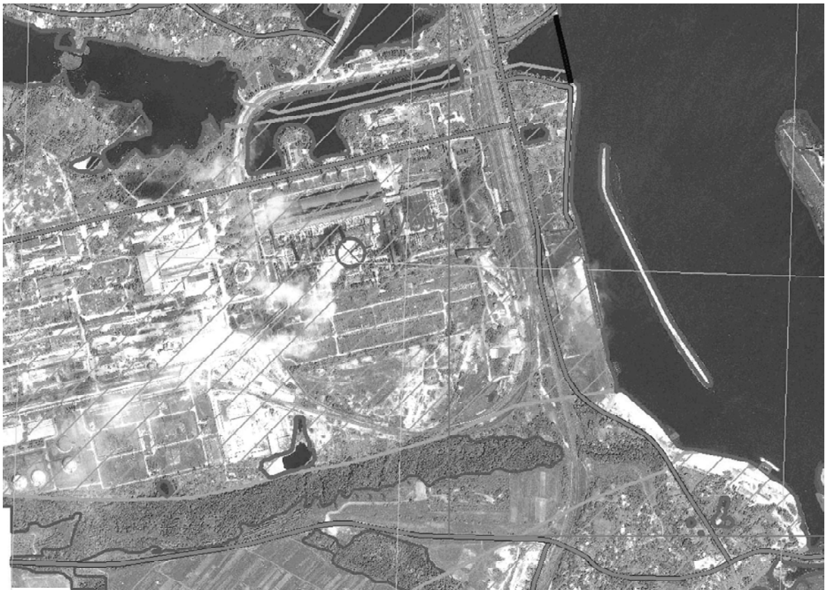
Рис. 2. Фрагмент космофотоплану на територію Канівського водосховища з віддешифрованими векторними шарами берегової лінії, лісів, мостів, контурів населених пунктів, причалів, навігаційних орієнтирів
