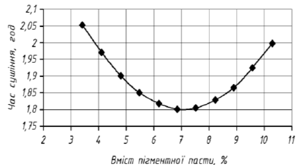
Рис. 13. Залежність зміни часу твердіння фарбувальної композиції від вмісту пігментної пасті, що вводиться
