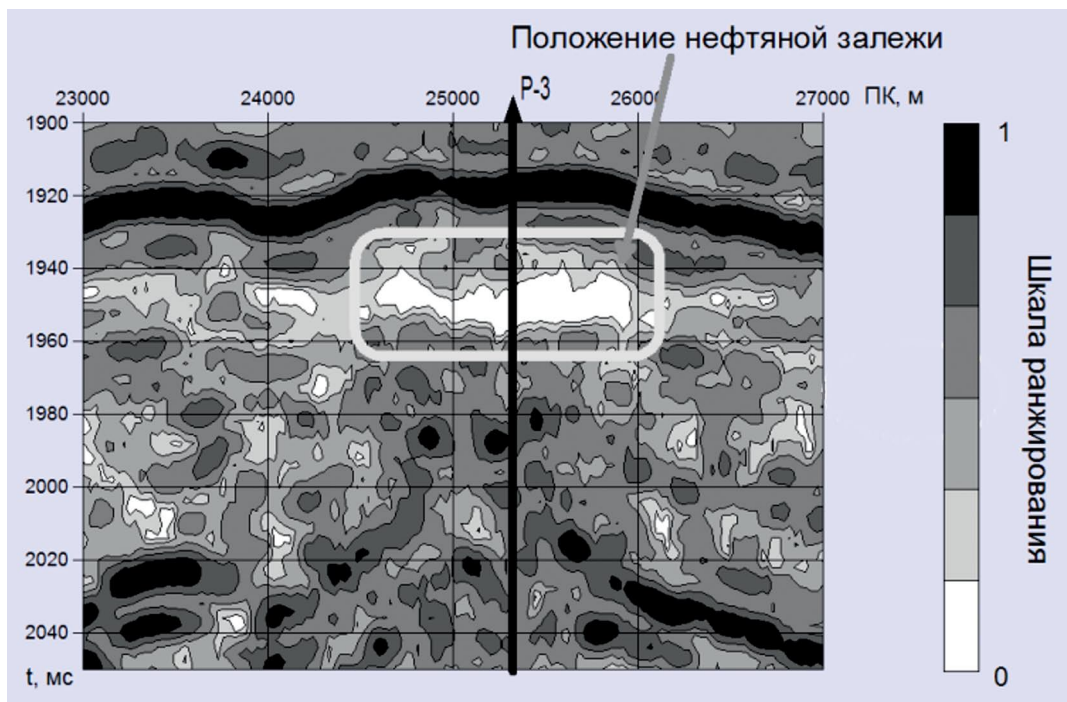
Рис. 11. Проявление нефтяной залежи на фазоэнергетическом разрезе (Болтная площадь, Томская обл.)
