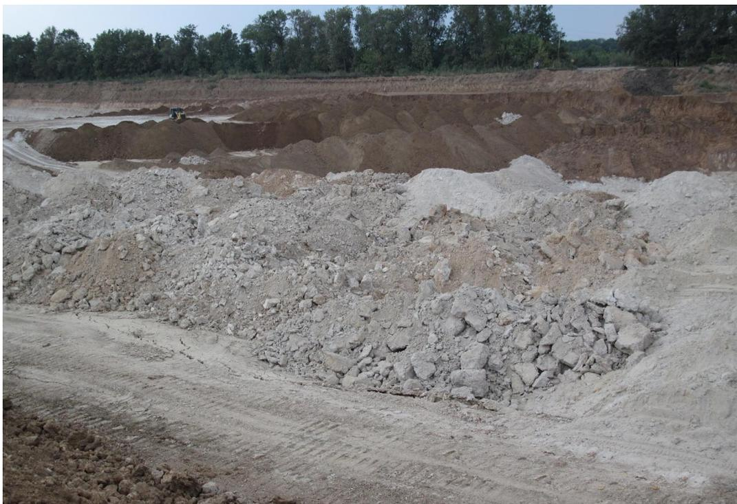
**Фото 3. Складирование “некондиционных” глин (марка НК) в отработанном пространстве карьера Опытного месторождения**
