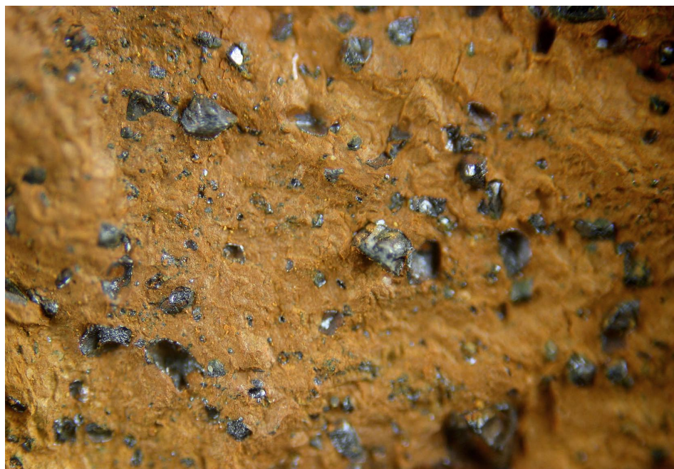
Фото 10. Структура поверхности и морфология зерен хромитов. Изображение под оптическим микроскопом, увеличение 40 x
