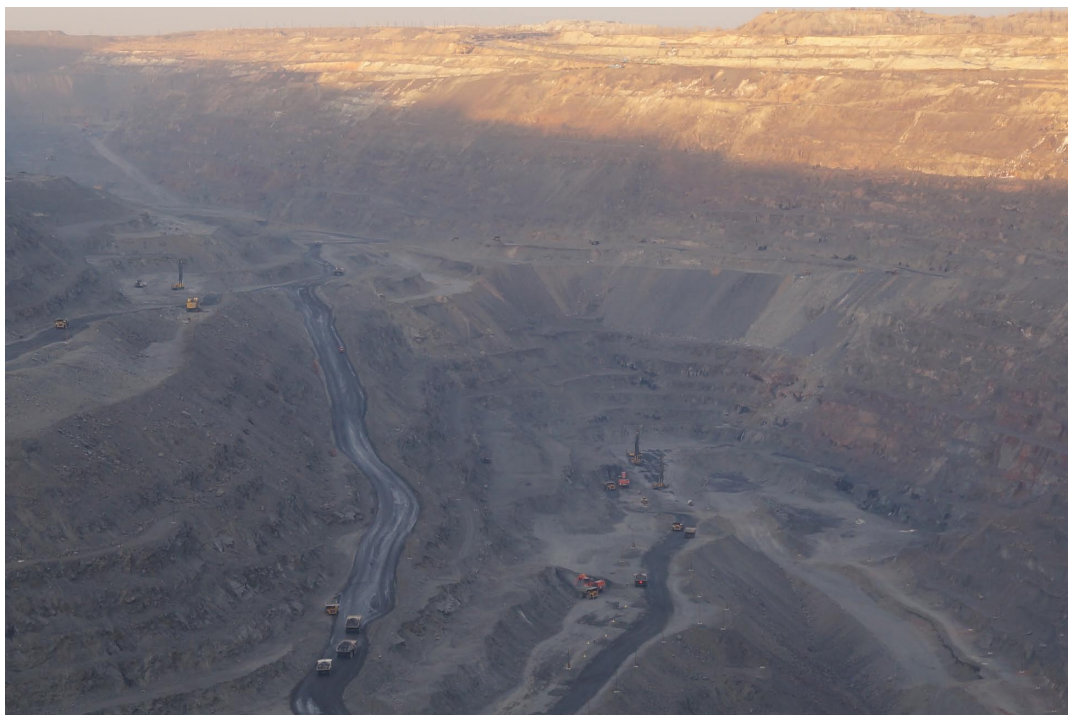
Фото 1. Панорама кар'єру ВАТ «Полтавський ГЗК». Заглиблена частина кар'єру узгоджується з положенням Горішньоплавнівського родовища. Північною частиною кар'єру (дальній план) розкрито Лавриківське родовище
