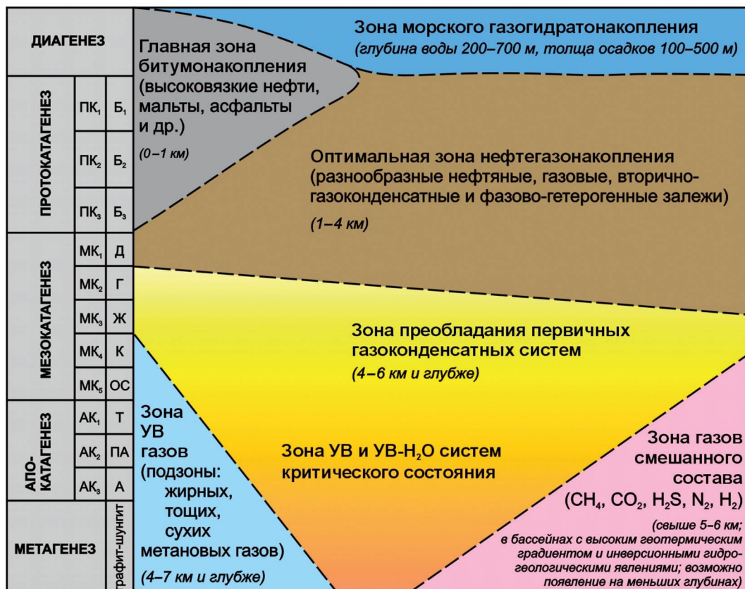
Рис. 4. Сводная схема зональности нефтидогенеза в осадочной оболочке (стратисфере)
