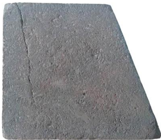
Рис. 9. Зразок ОВ-825-35. Руда мартитова, масивна, порувата
