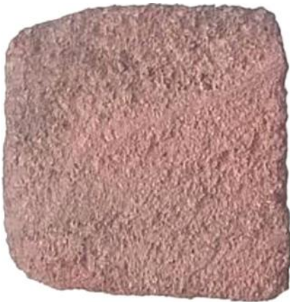
Рис. 12. Зразок ОВ-330-167. Руда мартит-дисперсногематитова, нечіткосмугаста, порувата, крихка
