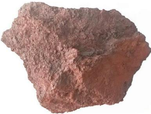
Рис. 11. Зразок ОВ-330-152. Руда дисперсно-гематит-мартитова, брекчієподібна, порувата, крихка
