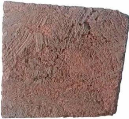
Рис. 10. Зразок ОВ-465-86. Руда дисперсно-гематит-мартитова, тонкосмугаста, плейчаста, порувата, кавернозна
