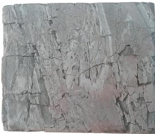
Рис. 8. Зразок ОВ-825-27. Руда мартитова, тонкосмугаста, плейчаста, кавернозна, тріщинувата
