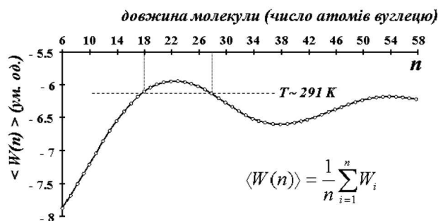
Рис. 7. Залежність середньої енергії взаємодії \text{CH}_2 -груп, \langle W(n) \rangle , молекул n -алканів, адсорбованих на Au(111). Розрахунок проведений для інтервалу 6 \leq n \leq 58 ( n – парні). Пунктирна пряма відтворює ділянку кривої \langle W(n) \rangle , що відповідає інтервалу нестабільності ( 18 \leq n \leq 26 )
