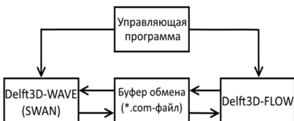
Рис. 1 – Схема работы комплекса интегрированных моделей Delft3D-FLOW + SWAN
