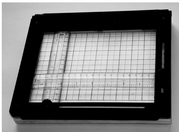
Рис. 1. Внешний вид градуированной прозрачной сетки для измерений и определения площади различных участков ТОГМ.
