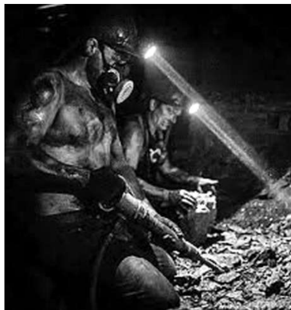
Рис. 5. Видобуток вугілля в уступних забоях з використанням відбійного молотка
