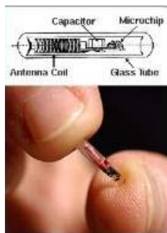
Рисунок 9. Вживляемая в организм человека RFID-метка
