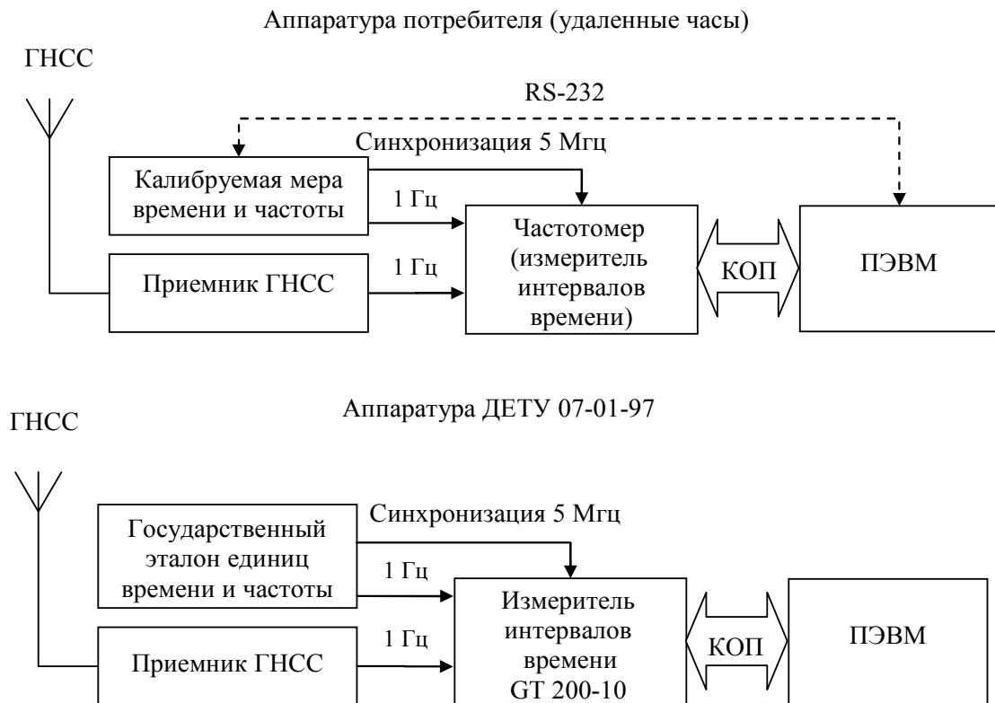
Рис. 3. Структурная схема комплекса аппаратуры для проведения калибровки удаленных часов
