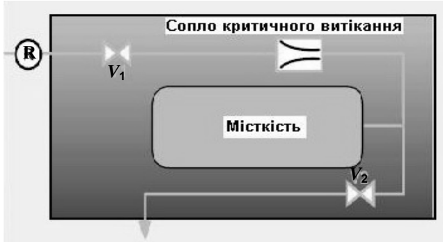
Рис. 4. Первинний еталон Франції PVTt-типу, LNE-LADG: V_1 – вхідний клапан; V_2 – вихідний клапан; R – редукуючий пристрій
