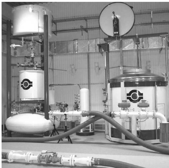
Рис. 2. Зовнішній вигляд еталона дзвоного типу з установкою еквівалентного витіснення
