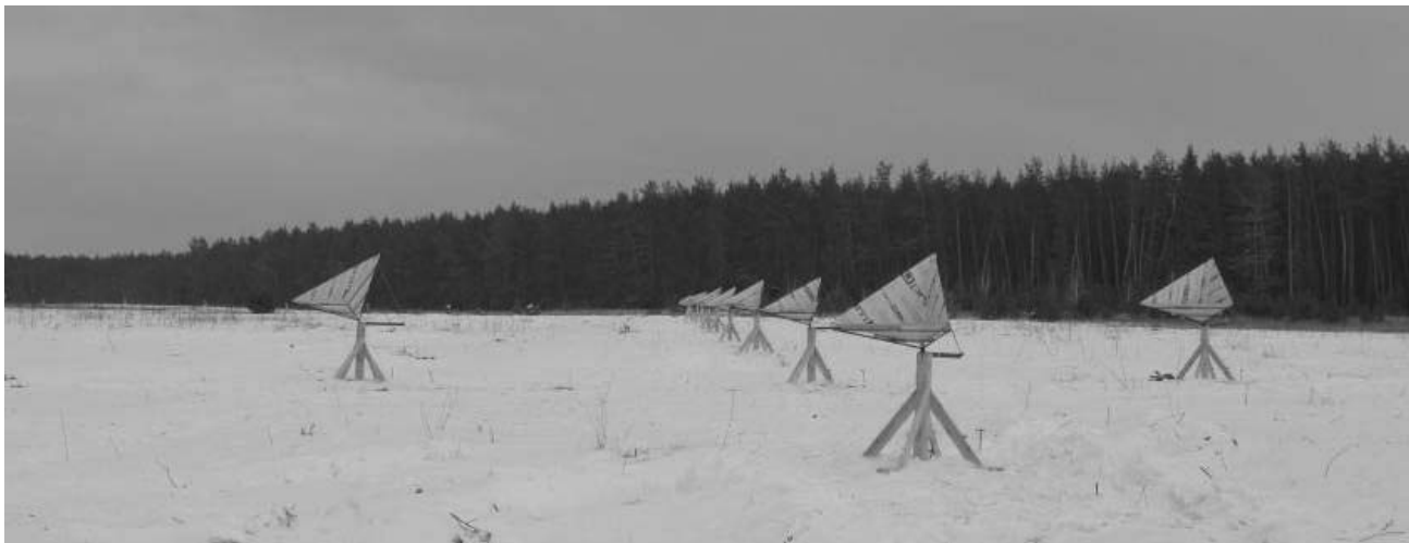
Рис. 1. Пространственная мира оценки разрешающей способности РСА на ККК "Скрипалі" в ходе ЛЭИ 14.02.2012 г.
