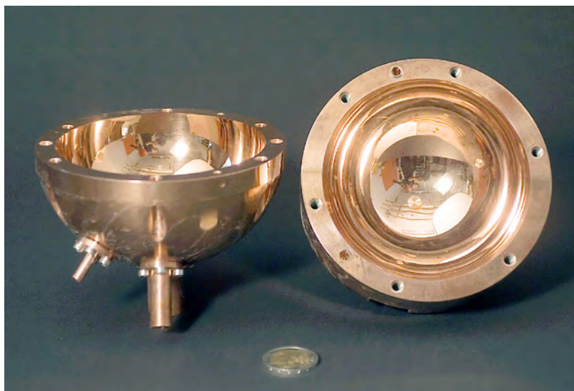
Рис. 1. Зовнішній вигляд квазінапівсфер VCU2v2 після ручного личкування
