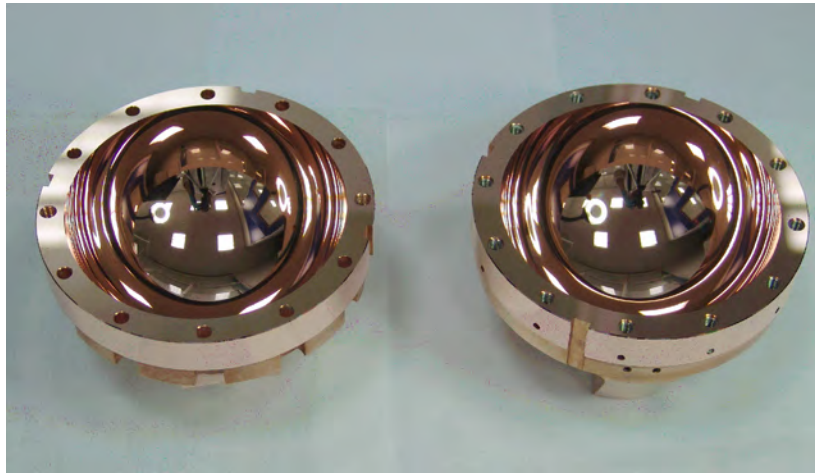
Рис. 2. Зовнішній вигляд квазінапівсфер VCU3 після алмазної обробки внутрішніх поверхонь
