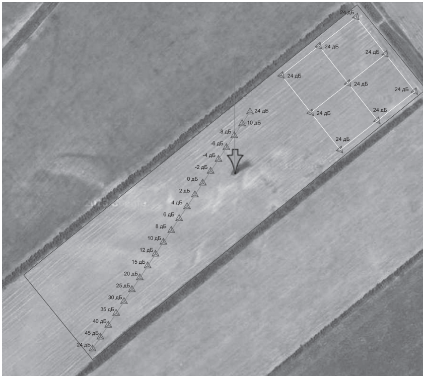
Рис. 6. Схема расстановки метрологических средств на ККК в Волгоградской области на подложке оптического космического снимка 06.11.2013 г.
