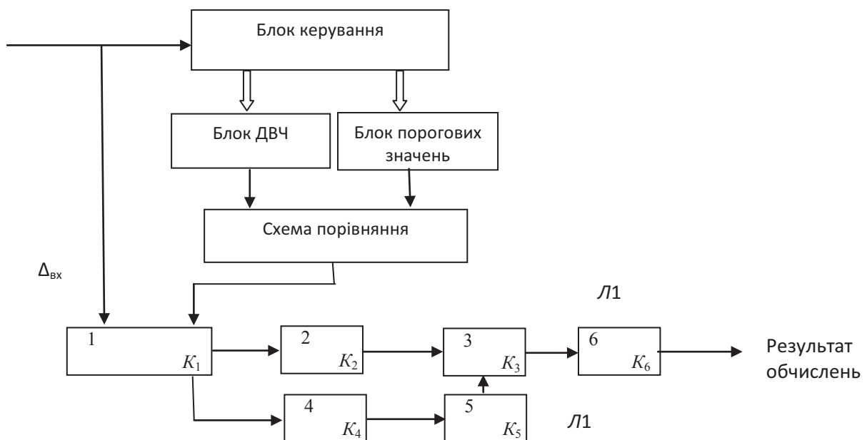
Рис. 3. Обчислювальний канал "гнучкої" структури в представленні ймовірнісного автомата: ДВЧ – датчик випадкових чисел; 1...6 – компоненти ОБК; K 1 ...K 6 – коефіцієнти перетворення похибок вхідних даних; Δ вх – похибка вхідних даних
