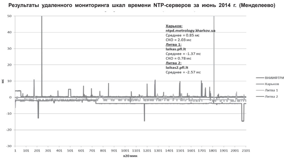
Рис. 4. Результаты сличений между серверами УМЦ ГСВЧ, Литвы и ФГУП “ВНИИФТРИ” за июнь 2014 г.
