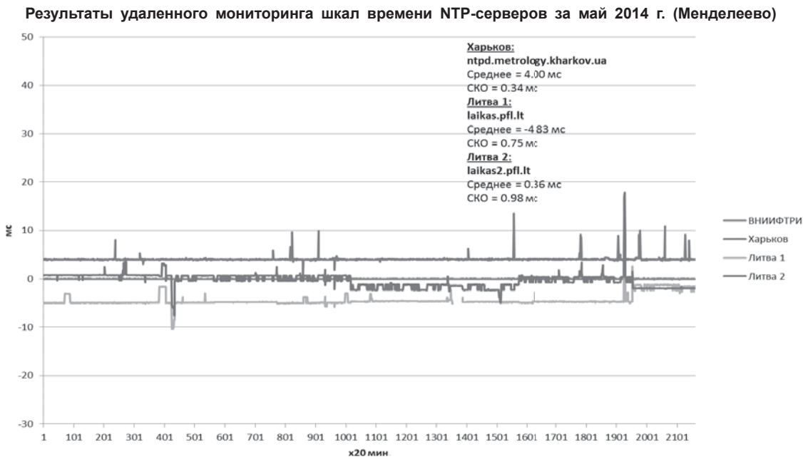
Рис. 3. Результаты сличений между серверами УМЦ ГСВЧ, Литвы и ФГУП “ВНИИФТРИ” за май 2014 г.
