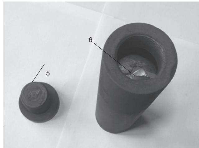
Рис. 2. Вид графитовой ампулы: 1 – оболочка графитовой камеры; 2 – гайка; 3 – излучатель-вставка; 4 – диафрагма; 5 – заглушка; 6 – металл (меди)
