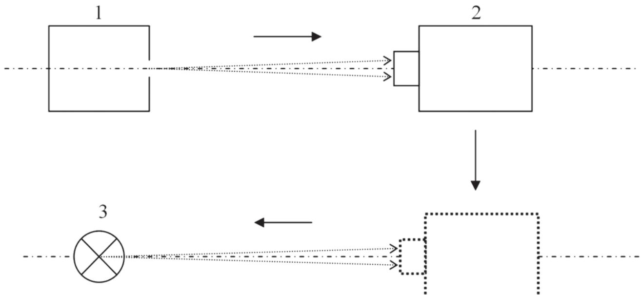
Рис. 8. Предложенные схемы проведения измерений: 1 – излучатель с реперной точкой меди; 2 – фотоэлектрический компаратор яркостей; 3 – эталонная температурная лампа
