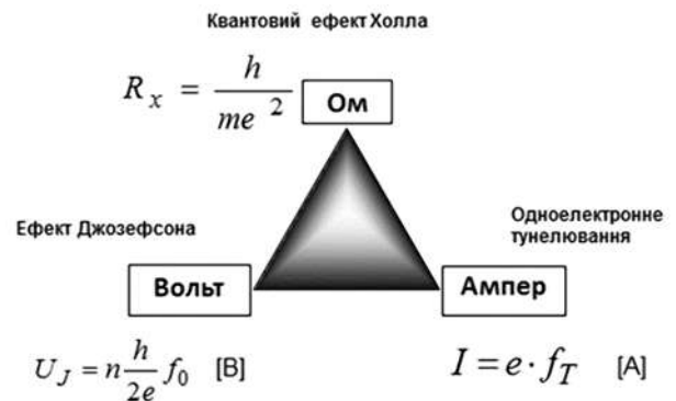
Рис. 3. Квантовий трикутник електричної метрології
