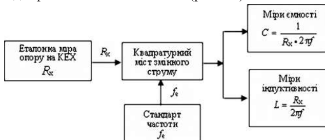
Рис. 10. Схема калібрування мір ємності та індуктивності за КЕХ
