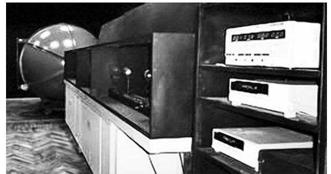
Рис. 2. Державний первинний еталон одиниці світлового потоку
