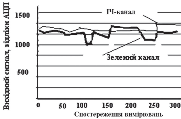
Рис. 14. Залежності сигналів ІЧ (тонка лінія) та зеленого (товста лінія) каналів при вимірюванні рівня гемоглобіну у пацієнта. Спостереження 1–51, 52–102, 103–153 — три точки біля ліктового суглоба передпліччя; спостереження 154–204, 205–305 — дві точки біля кисті
