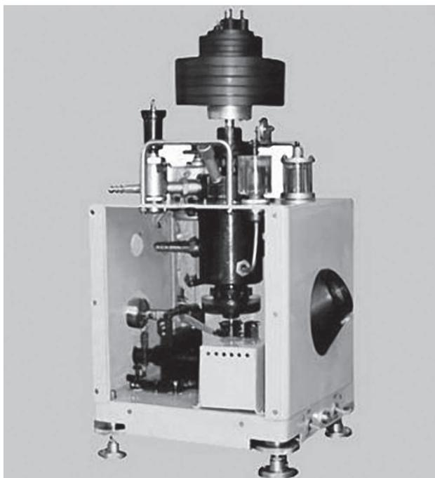
Рис. 2. Манометр абсолютного давления МПА-15
