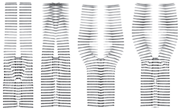
Рис. 1. Распределение вектора деформации в центральном сечении датчика в различные моменты времени по данным [6]
