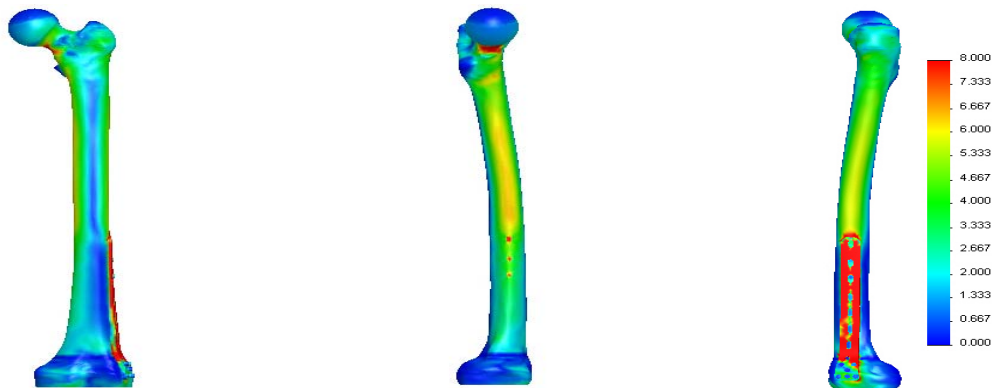
Рис. 2. Розподіл напружень Мізеса в розрахунковій кінцевих елементів моделі 1.
